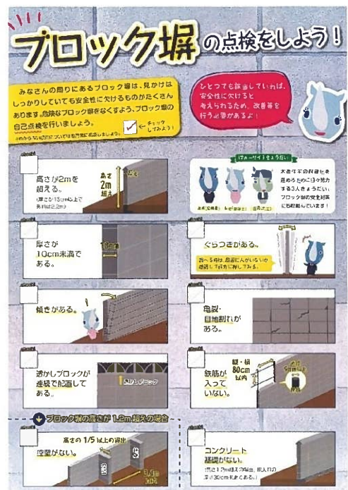
図-ブロック塀点検啓発チラシ 発行：愛知県建築物地震対策推進協議会
