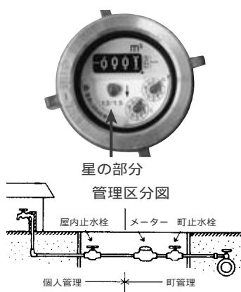
各家庭に設置してある水道のメーターから内部に配管されている部分は個人管理です。
