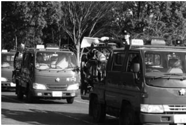
現在、各分団に配備されている小型動力ポンプ付積載車
