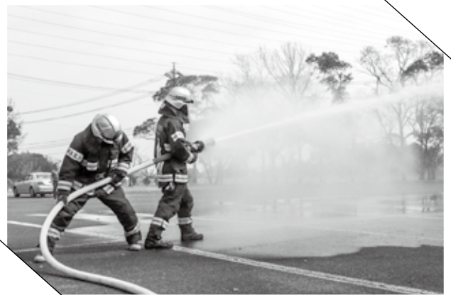
▲ 自衛噴霧機能の付いた新型放水ノズルの実力
